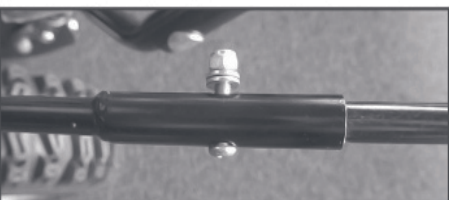
Соединение нижней и верхней части рычагов поворота желоба
