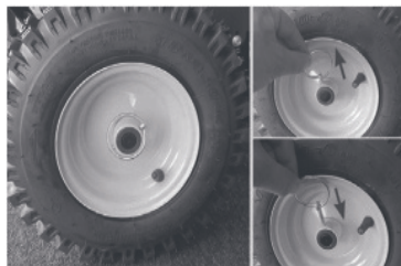
Установка шплинта на левом колесе
